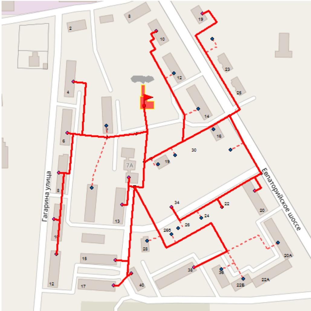
Рисунок 2 – Схема и структура тепловых сетей от котельной ГУП РК «Крымтеплокоммунэнерго» (п.г.т. Раздольное, Евпаторийское шоссе,14а)
